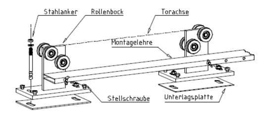
• Stellen Sie die Rollen, wie unten dargestellt auf das Fundament richtig ein. Benutzen Sie eine Wasserwaage! Die Unterlagsplatten müssen unter den Rollen gelegt werden!
