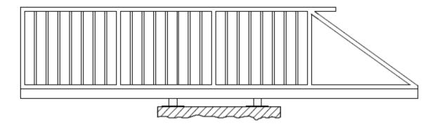
Verschrauben Sie die Endplatten des Laufprofils. Stellen Sie dann das Tor zu der Auflaufrolle so ein, dass es leicht eingeht. Drehen Sie die Stellschrauben der Auflaufrolle nach oben oder nach unten wie erforderlich und beachten Sie die waagerechte Position!
