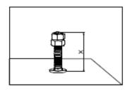
• Nach dem Fixieren können Sie die Rollenböcke mit Hilfe von den 4Stk. Stellschrauben (auf der Bodenplatte) waagerecht einstellen
